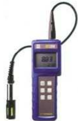
آلة لقياس الحرارة وكمية الأوكسجين
